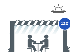
Lamas en 120° permite entrada total de luz solar, incluso en puestas de sol.
